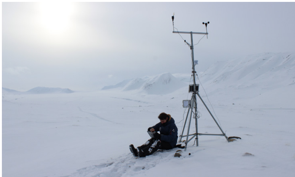
Гидролог-исследователь снимает данные с автономной метеорологической станции, расположенной у подножья ледника Восточный Грён-фьорд.
