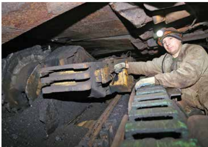
Электрослесарь участка добычи угля Вадим Упатов производит обслуживание комбайна.
