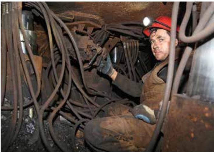
ГРОЗ Александр Тимошенко производит ремонт и обслуживание механизированного комплекса.
