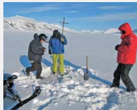
Измерения снежного покрова в долине Грендален. «Крест-пробойник» используется для разрушения плотного снега, содержащего прослойки льда
