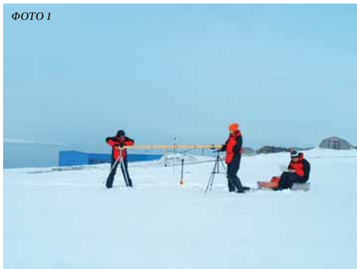
Измерения прямой (фото 1) и суммарной (фото 2) солнечной радиации в поселке Баренцбург. ФОТОГРАФИИ: П.СВЯЩЕННИКОВ
