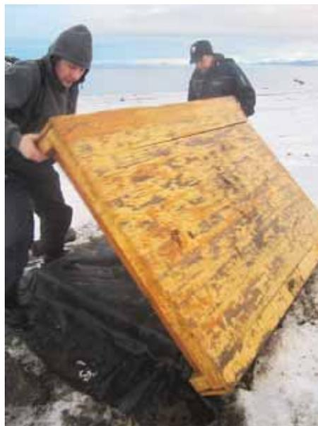
*Сотрудники ПГИ А.В.Ролдугин и А.В.Роскуляк заканчивают установку магнитометра внутри специального немагнитного короба.*
