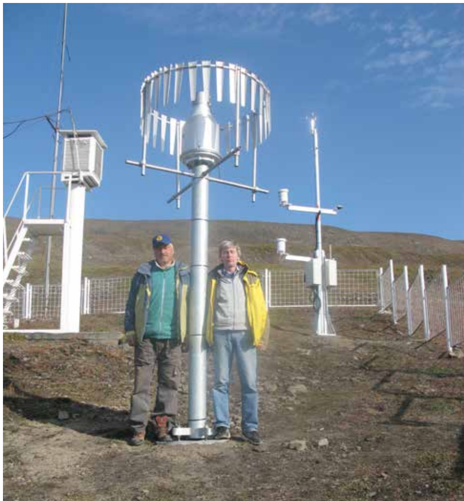
Норвежский осадкомер GEONOR (в центре) и усовершенствованная двухуровневая АМС (справа на заднем плане). Специалисты, занимавшиеся установкой осадкометра и «настройкой» АМС: завлаборатории ААНИИ Борис Иванов (слева), завкафедрой климатологии СПбГУ Павел Священников. ФОТОГРАФИЯ ПРЕДОСТАВЛЕНА БОРИСОМ ИВАНОВЫМ
